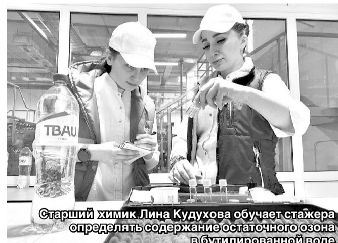
Старший химик Лина Кудухова обучает стажера определять содержание остаточного озона в бутилированной воде
