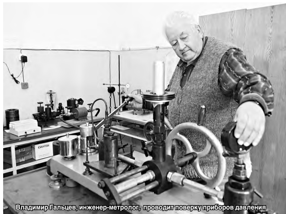
Владимир Гальцев, инженер-метролог, проводит проверку приборов давления
