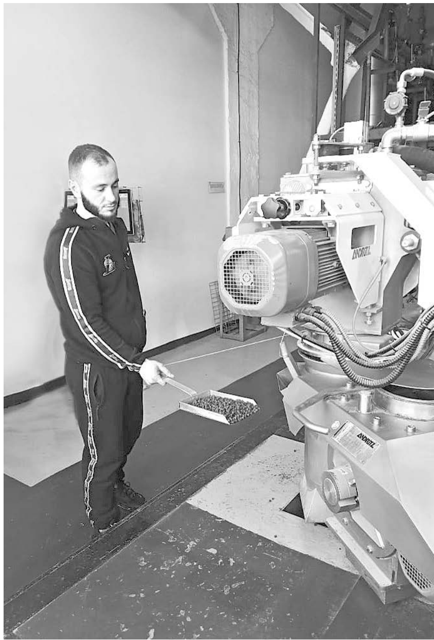
Рецептура комбикорма задается автоматически. Закладывая данные на сырье, нажимаю на кнопку – и процесс пошел. В зависимости от используемых компонентов можно приготовить корм для крупного рогатого скота, овец, свиней, птицы и даже для рыбы и домашних питомцев.
