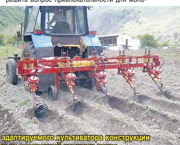
Испытание адаптируемого культиватора конструкции ГГАУ в горах на засоренной камнями почве.
