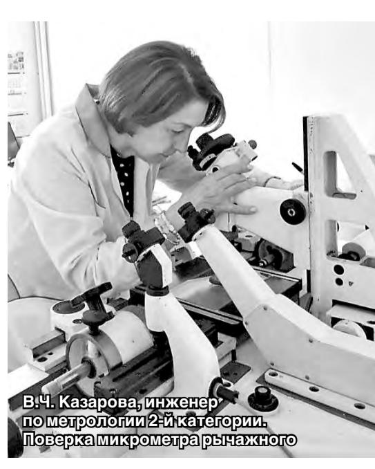
В.Ч. Казарова, инженер по метрологии 2-й категории. Проверка микрометра рычажного
